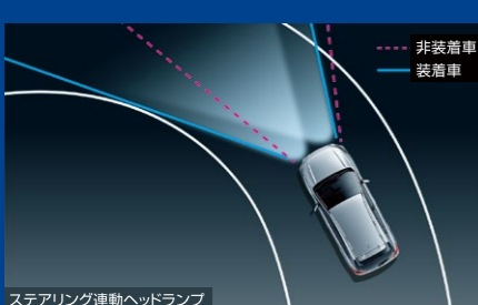
ステアリング連動ヘッドランプ
